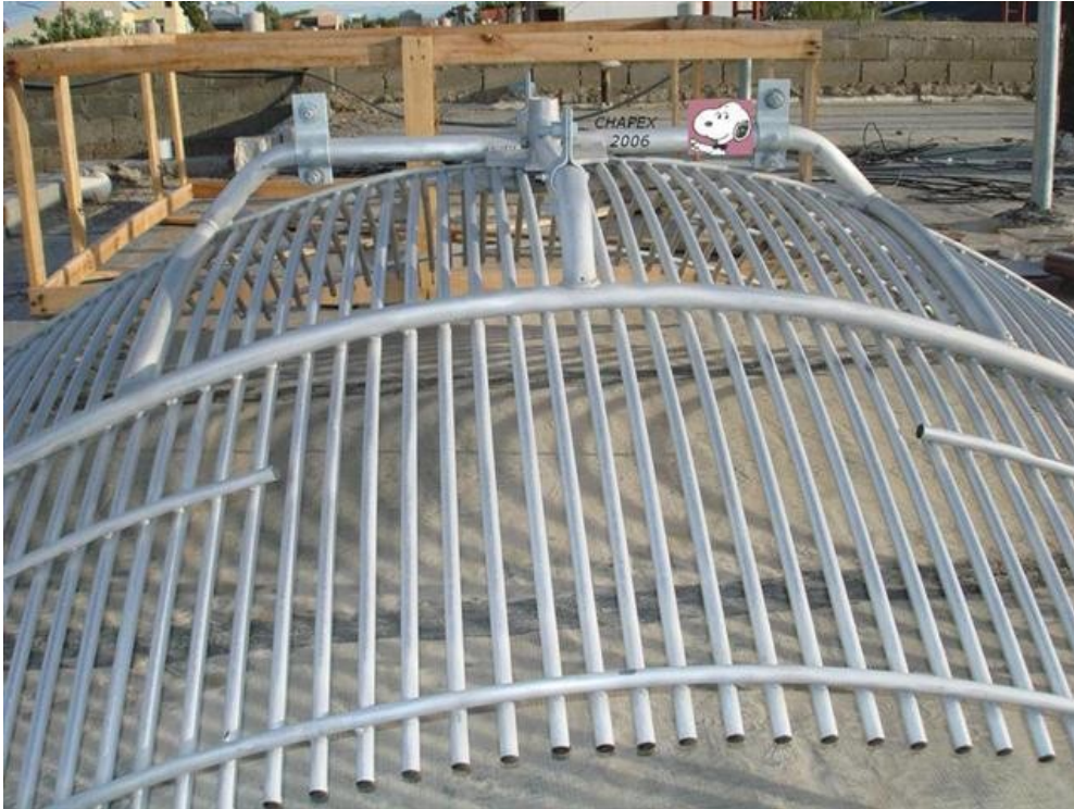
Vistas frontales y traseras de la antena con el dipolo colocado.
